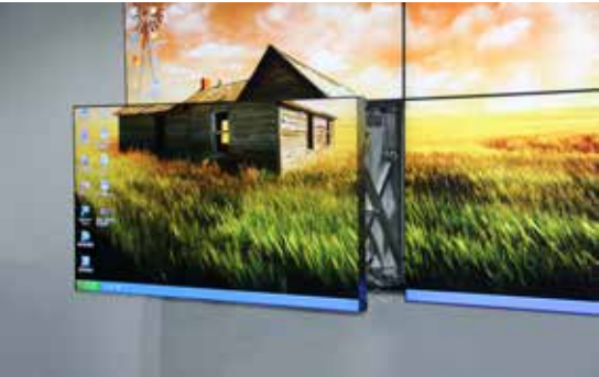
前维护带装修（前视角）
